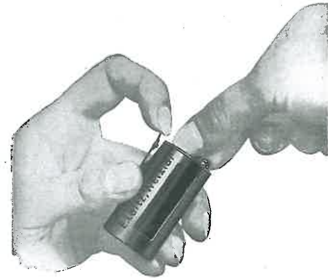
Fig. 8. Wie man die Kassette B öffnet.
