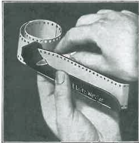
Fig. 22. Anschneideschablone. (Filmanschnitt für Gegenspule).
